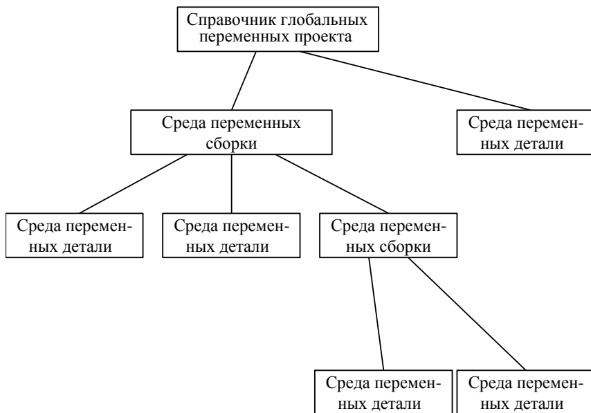
Рис. 7.22. Структурная схема среды переменных проекта
