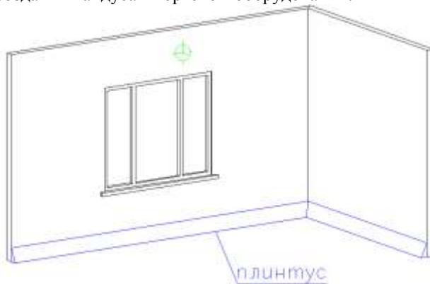
Рис. 4.18 Пример установки плинтуса
